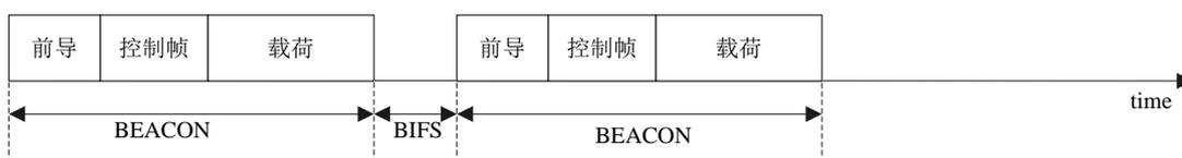
图12 突发帧间隔示意图
