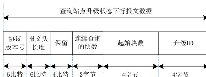
图26 查询站点升级状态下行报文数据格式
